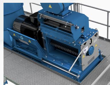
Martelos com revestimento duro com quatro superfícies utilizáveis – todas as quatro bordas podem ser utilizadas antes que seja necessário um novo conjunto. A planta de moagem vem com uma bandeja de serviço inserível para eliminar o risco de queda de martelos desnecessariamente na máquina.
